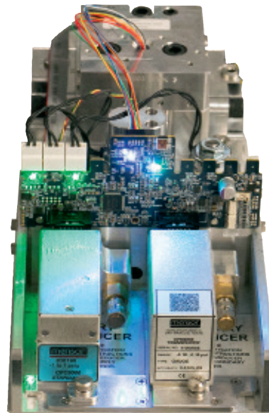
Mit bis zu zwei Sensoren ausgestattetes Druck- modul
