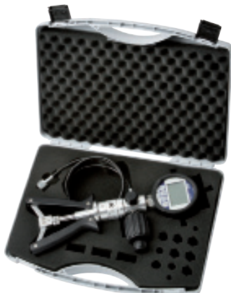
Grundausstattung inkl. pneumatischer Druckerzeugung
