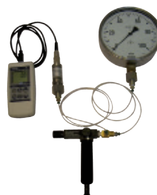
Applikation Kalibrierung mit Handprüfpumpe Typ CPP7 und Referenzmessgerät Typ CPH6200
