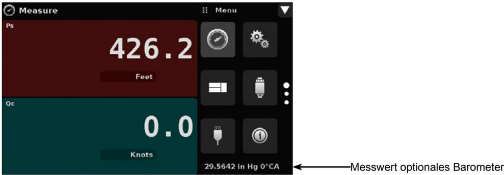
2-fach-Anzeige Kanal „PS“ und „QC“ mit zusätzlicher Anzeige
