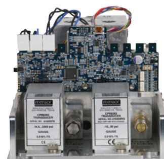
Mit bis zu zwei Sensoren ausgestattetes SVR-Druckmodul
