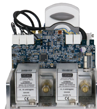
Mit bis zu zwei Sensoren ausgestattetes LPPump-Modul
